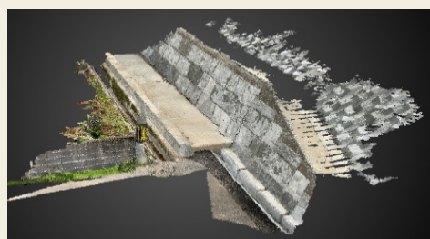
図8 LiDERで取得した点群データ例
